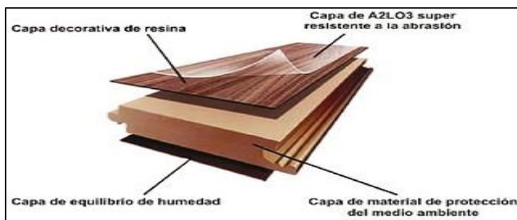
Ilustración 12. Composición del piso flotante
