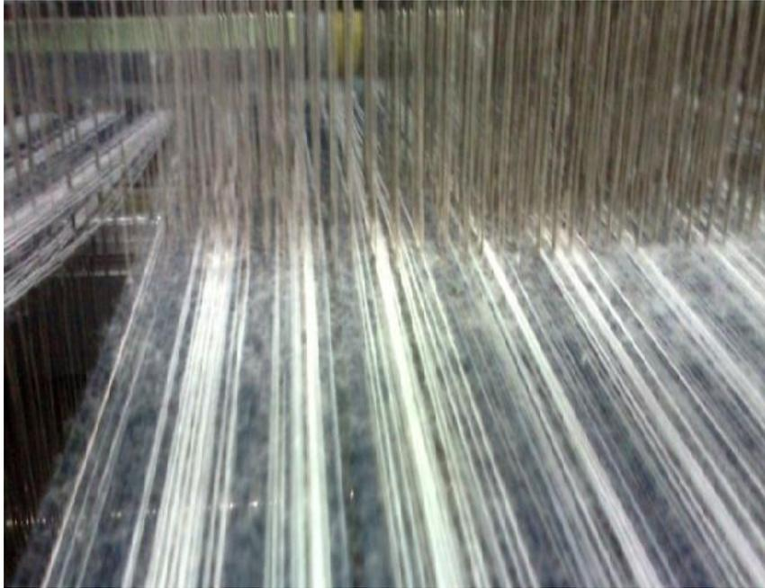
Fig.111 Hilos de urdido contaminado con pelusa del ambiente.
