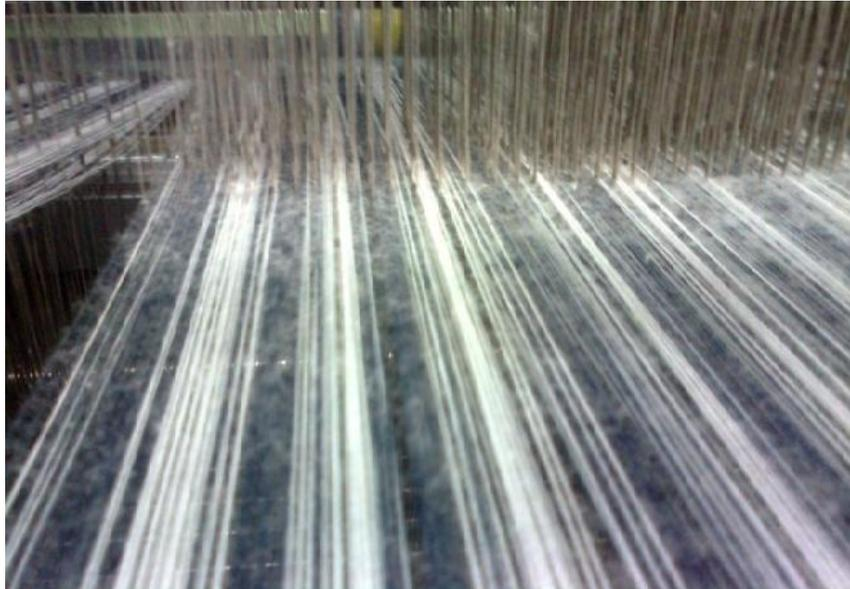
Fig.119 Pelusa del ambiente depositada en el hilo de urdimbre.
