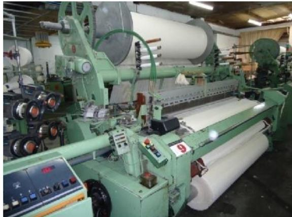
Fig.31 Telar de pinzas rígidas.
