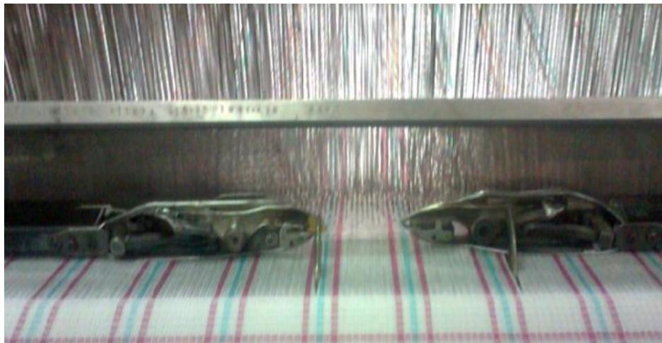
Fig.32 Pinzas rígidas.
