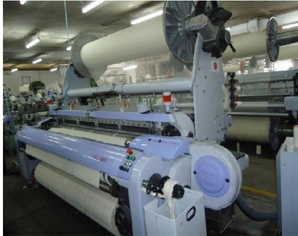
Fig.33 Telar de pinzas flexible.
