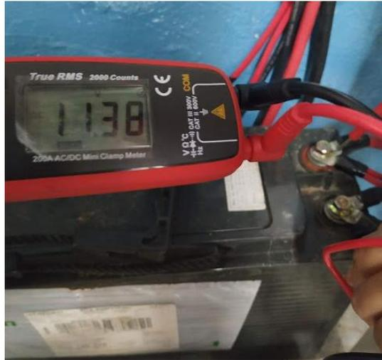
Figura 44. Prueba de voltaje en batería.
