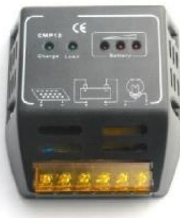
Figura 8. Regulador de carga del sistema.
