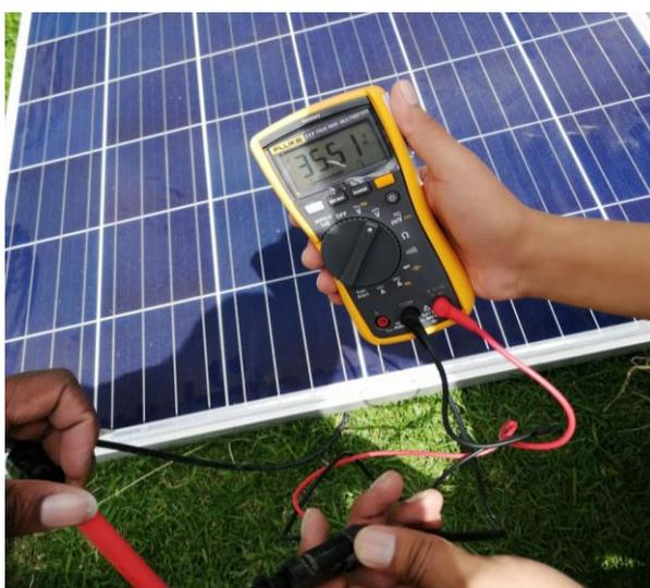
Figura 42. Mediciones de voltaje en circuito abierto.
