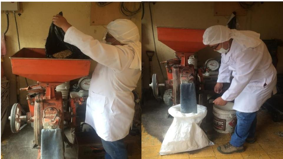
**Figura 9.** Molienda del bagazo seco
