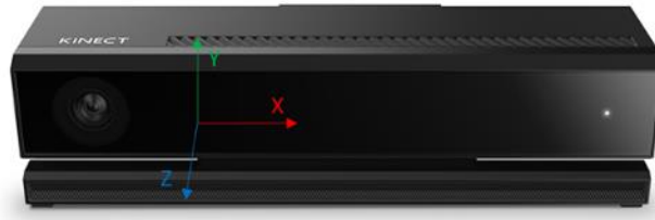
Fig. 26. El espacio de la cámara se coordina desde el Kinect Fuente: [25] .
