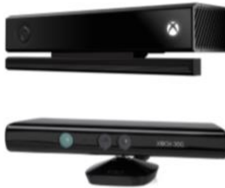
Fig. 19. Dispositivos Kinect Xbox 360 y Kinect para Xbox one Fuente: [22]
