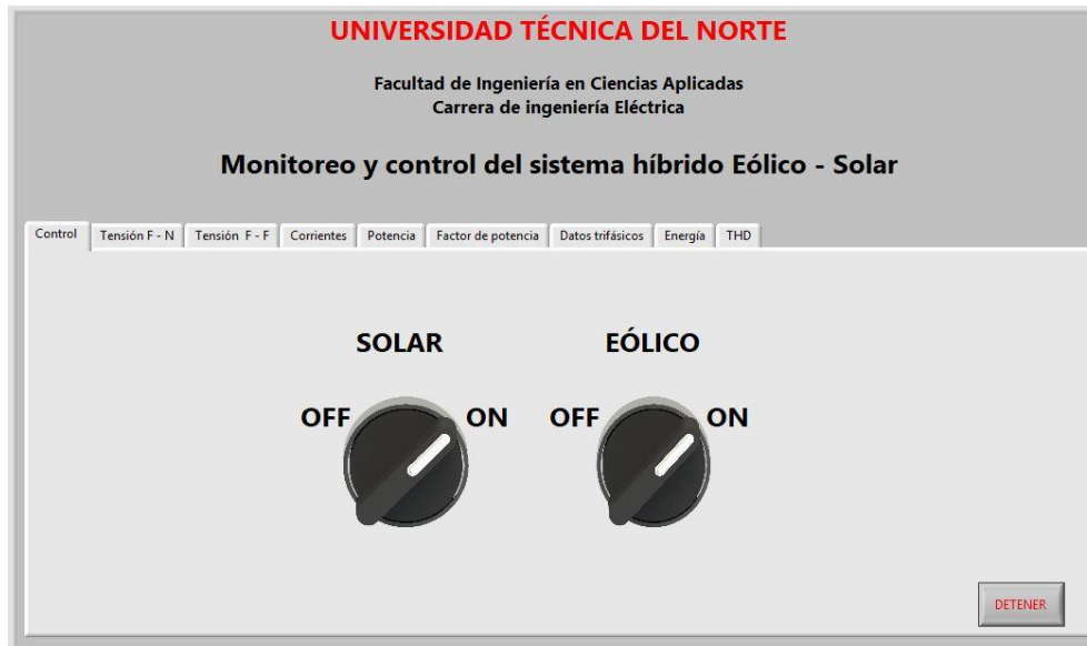
Fig. 43. Interfaz realizada en LabVIEW para visualizar y controlar los sistemas de generación.
