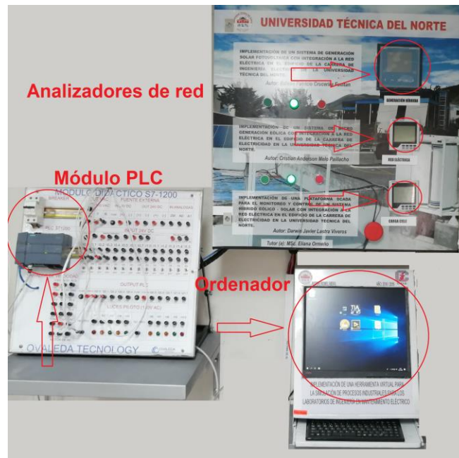
Fig. 70. Implementación completa del sistema SCADA.
