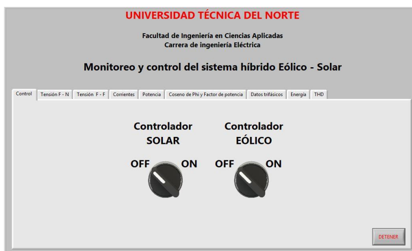
Fig. 2. Interfaz de un sistema SCADA.
