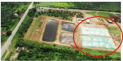
Ilustración 17: Laguna de estabilización Anaeróbia
