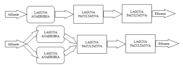
Ilustración 22: Configuraciones de lagunas en serie y/o paralelo
