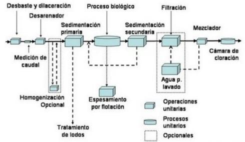
Ilustración 6: Diagrama de flujo de tratamiento de aguas residuales.
