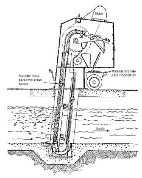
Ilustración 31: Rejillas Mecánicas
