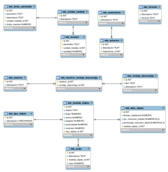
Ilustración 35: Diagrama Relacional del Módulo de Análisis de Efluentes del Proyecto
