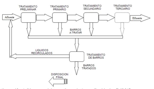
Ilustración 4: Diagrama del tratamiento de Aguas Residuales [LIB01]
