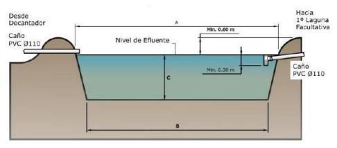
Ilustración 18: Esquema de una Laguna Anaeróbia
