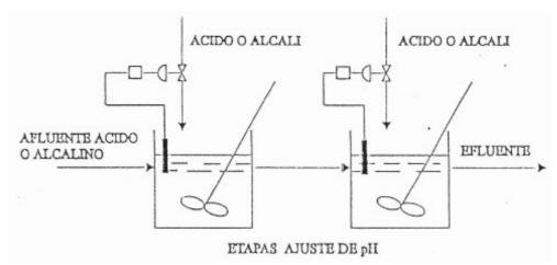
Ilustración 11: Sistema de ajuste de pH corrientes ácidas o alcalinas
