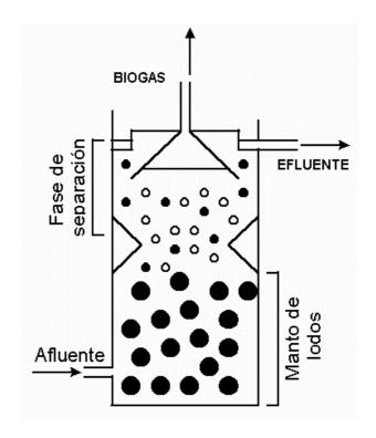
Tabla 11:Esquema de un Reactor UASB [WEB29]
