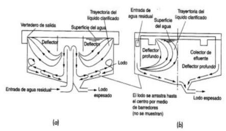
*Ilustración 14: Tanques circulares (a) alineación central (b) alineación perimetral*
