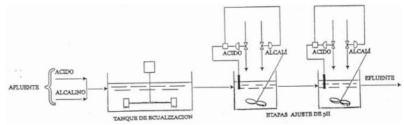
Ilustración 10: Sistema para ajuste de pH corrientes ácidas y alcalinas [LIB01]
