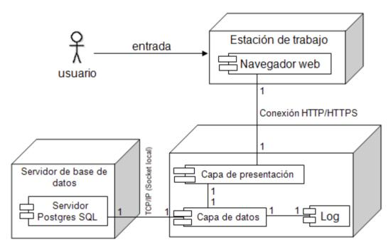
Ilustración 45: Diagrama de despliegue
