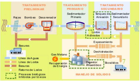
Ilustración 5: Componentes comunes de una Planta de Tratamiento de Aguas
