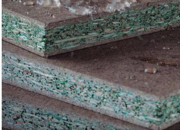
**Ilustración 2** Composición de los paneles de madera
