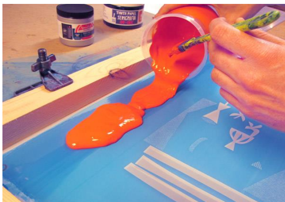
Figura 29. Proceso serigrafía. Colocación de pasta pigmentada. Fuente: (Vostok, 2013).
