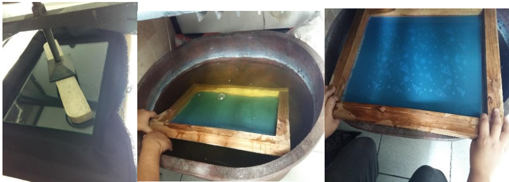
a) Revelado pantalla con diseño b) Lavado pantalla con diseño c) Secado pantalla con diseño
