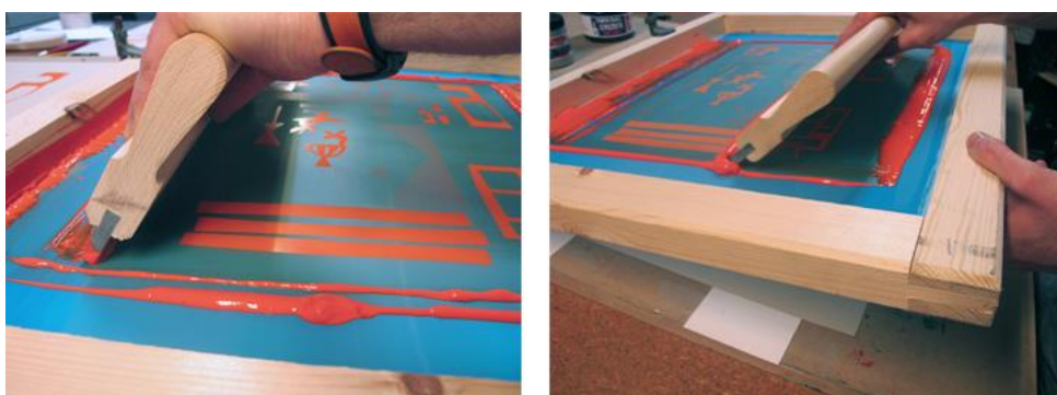
Figura 30. Proceso serigrafía. Cubrir malla. Fuente: (Vostok, 2013).
