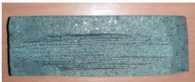
Figura 4.7 Desgaste sufrido en la probeta de cerámica
