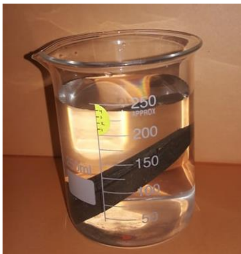
Figura 4.5 Pastilla de freno sumergida en el vaso de precipitación
