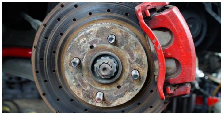
Figura 2.10. Desgaste por corrosión en frenos (Carroya.com, 2016, pág. 1)
