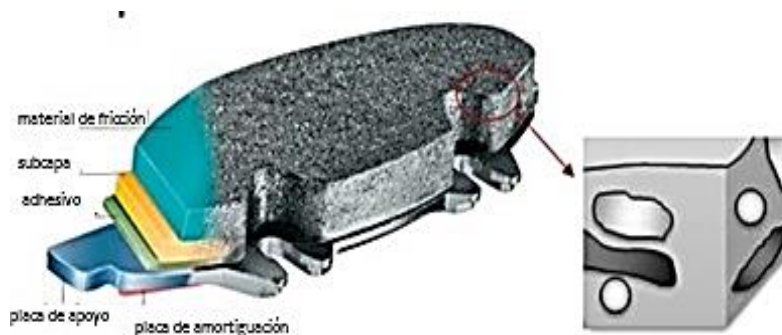
Figura 2.7. Estructura de la pastilla de freno (Chrysoula, 2014, pág. 4)
