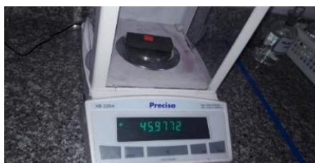
Figura 4.1 Pesaje de las probetas
