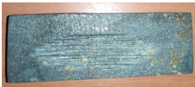
Figura 4.8 Desgaste sufrido en la pastilla de freno metálica
