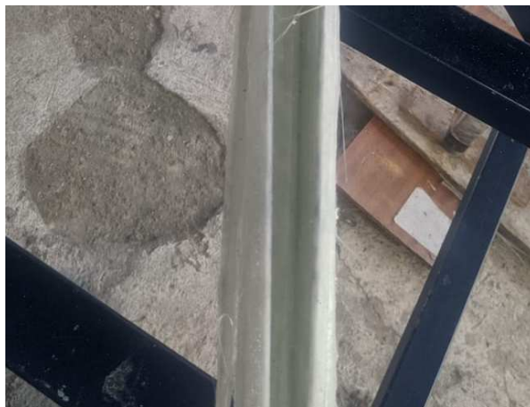
Figura 36: Prueba 3-Perfil frágil que muestra mejor compactación entre fibras y resina
