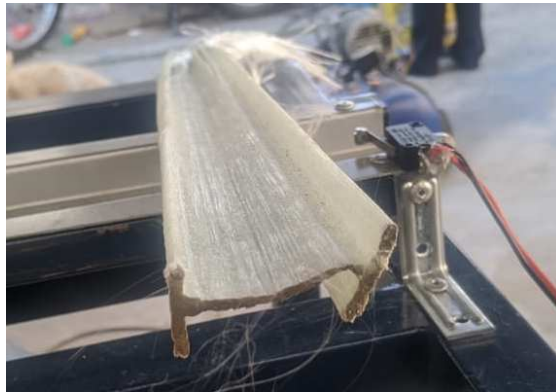
Figura 41: Prueba 7-Perfil frágil con una excelente interfaz entre matriz y refuerzo
