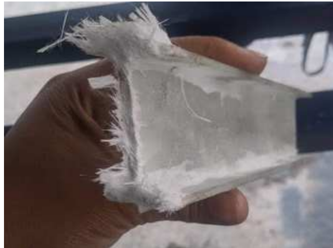
Figura 39: Primera prueba de corte-Se produce una delaminación en su estructura
