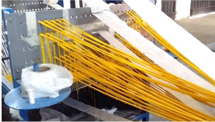
Figura 8: Sistema de pre-formado que también ayuda a quitar el exceso de resina [22]
