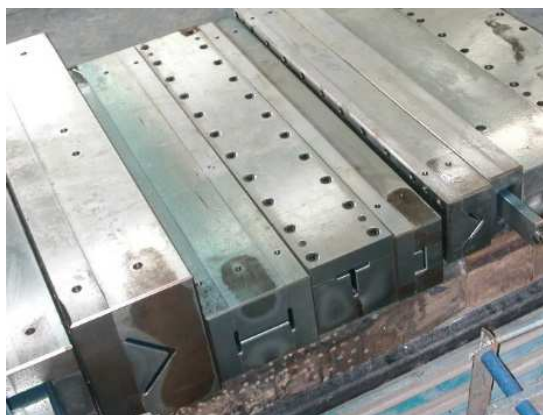
Figura 9: Moldes de acero con diferentes geometrías para el proceso de pultrusión [23]
