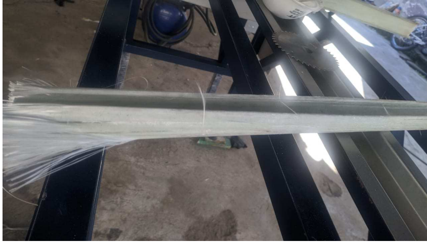
Figura 38: Prueba 5-Perfil frágil con mejor compactación, pero poroso
