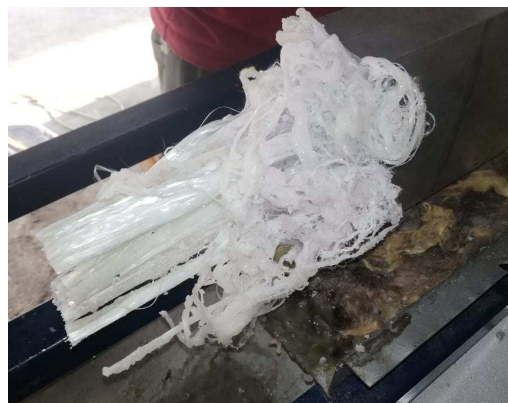
Figura 49: Prueba 12- Polimerización anticipada en el ingreso del molde
