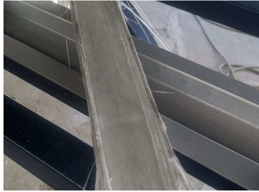
Figura 44: Prueba 10-Perfil resistente con un buen curado del material
