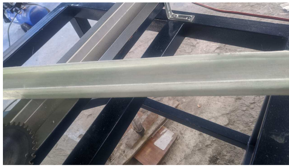
Figura 48: Prueba 14- Perfil resistente con un excelente curado
