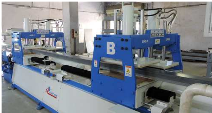
Figura 11: Cilindros reciprocantes que realizan el arrastre del perfil cuando sale del molde [25]
