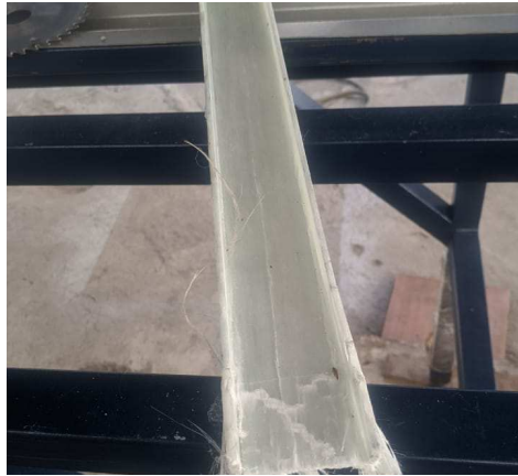
Figura 47: Prueba 13 –Perfil que presenta cierto nivel de cristalización
