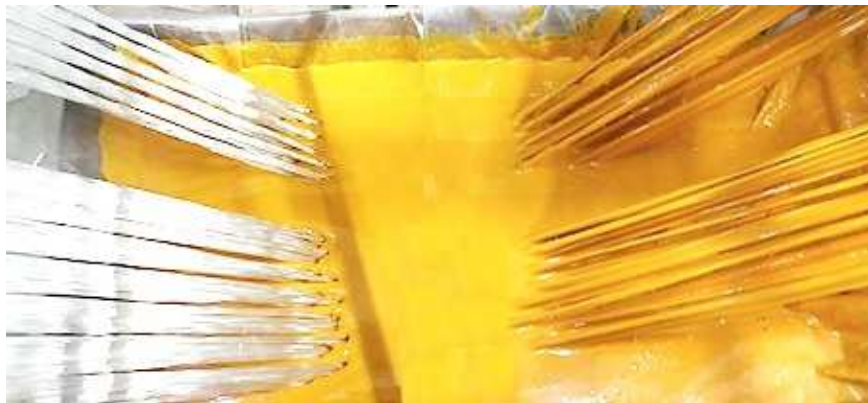
Figura 7: Ingreso y salida de las fibras de refuerzo en el tanque con resina y demás aditivos [20]
