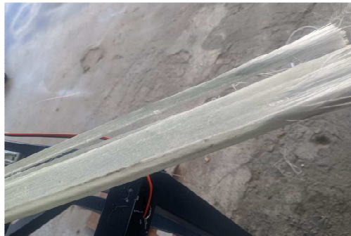
Figura 43: Prueba 9- Perfil frágil con distribución de fibras irregular
