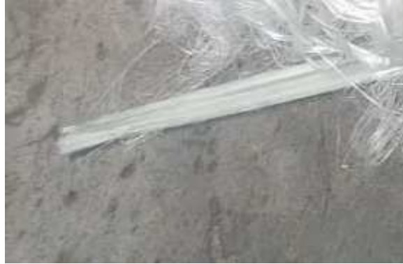
Figura 34: Prueba 1-Perfil con una estructura demasiado frágil
