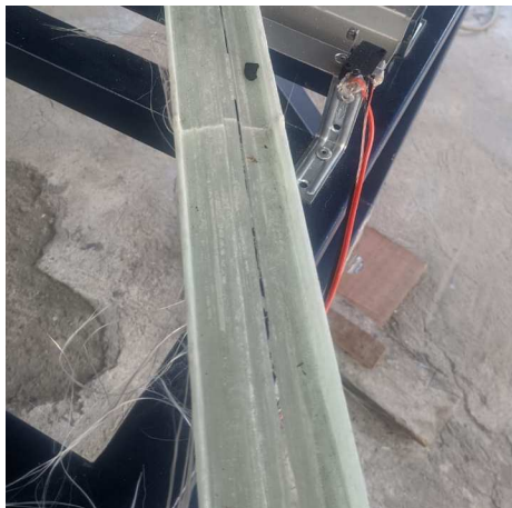
Figura 37: Prueba 4-Perfil frágil con ciertas partes que no se compactaron correctamente
