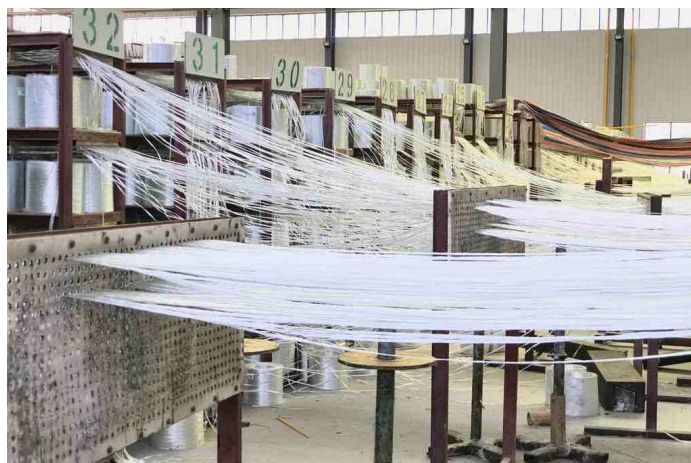
Figura 6: Carretes con hilos roving ubicados en estanterías enumeradas que pasan a través de guías [19]
