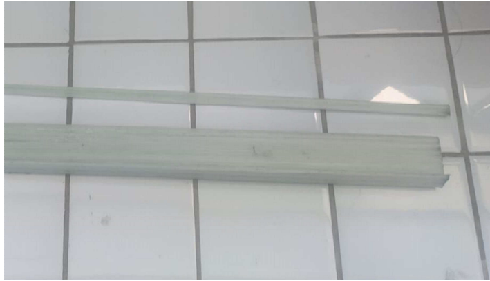
Figura 40: Prueba 6-Perfil resistente con incorrecta distribución de fibras en una parte
