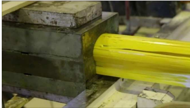
Figura 14: Primera salida del perfil pultruído [29]
