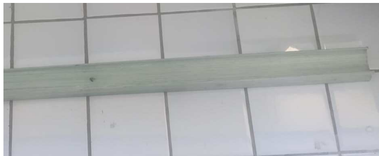
Figura 46: Prueba 11: Perfil resistente con un buen curado
