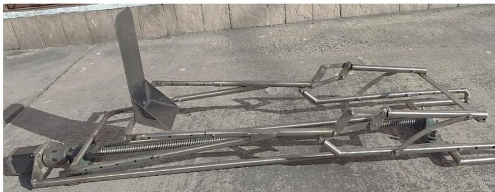
*Figura 4. 37. Ensamble de la estructura del rehabilitador.*
