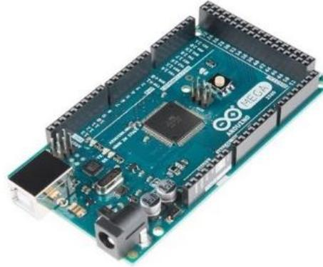
Figura 4. 32. Arduino Mega 2560.
