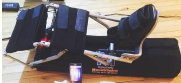
*Figura 2. 12. Prototipo de rehabilitador pasivo de rodilla [20].*
