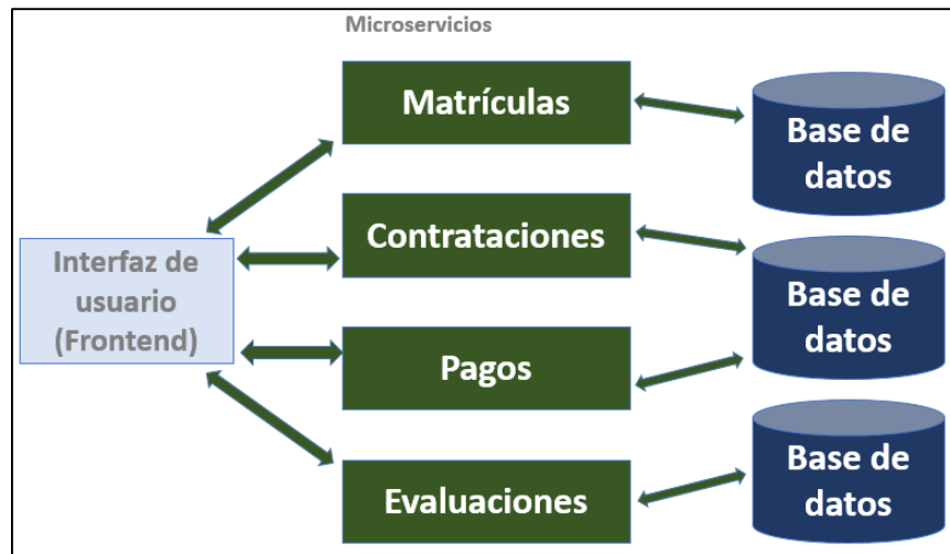
Fig. 4. Estructura de la arquitectura microservicios Fuente: Elaboración propia
