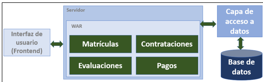
Fig. 3. Estructura de la arquitectura monolítica Fuente: Elaboración propia
