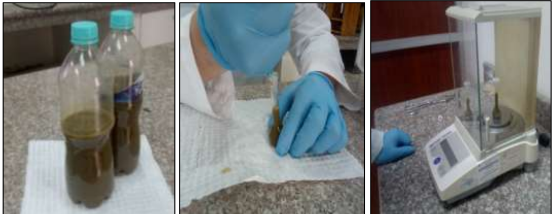
Fotografía 4. Medición de densidad de las muestras de sustrato de reactores
