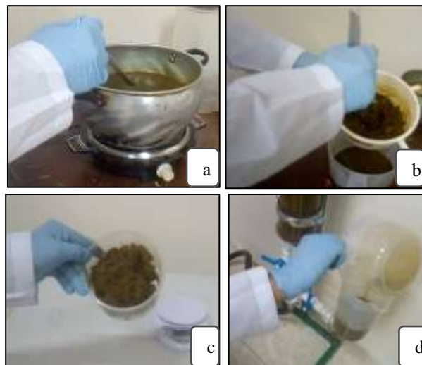
Figura 16. Ingreso de materia orgánica: a) Sustrato calentado, b) Sustrato cernido, c) Residuo sustrato cernido, d) Ingreso de sustrato al reactor UASB
