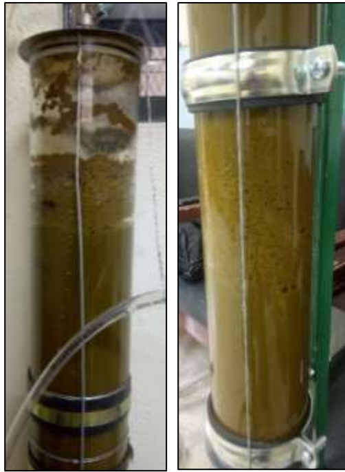
Fotografía 5. Estratificación de la mezcla en reactor 2 antes de cernir sustrato de ingreso (parte media y superior)
