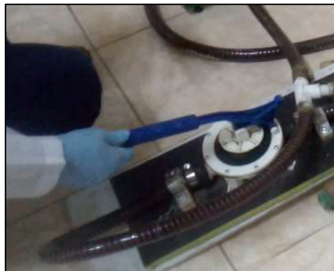
Figura 14. Bomba manual de diafragma para homogenizar sustrato
