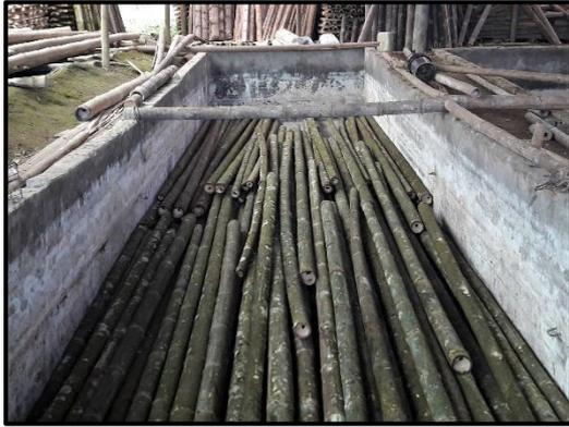
*Ilustración 13.* Colocación del material rollizo en la piscina de preservación.
