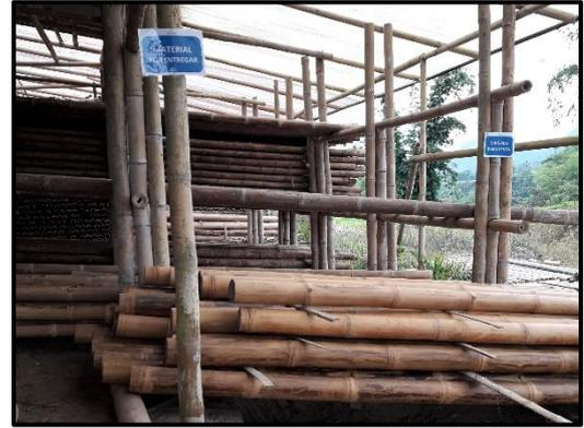
*Ilustración 14.* Secado del material rollizo en el centro de acopio.
