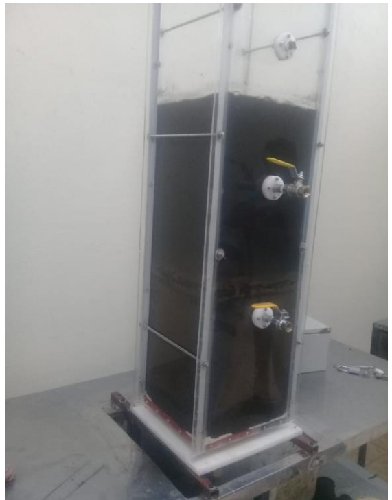
Anexo 1. Reactor secuencial tipo Batch (SBR), vacío y con carga de agua de la PTAR
