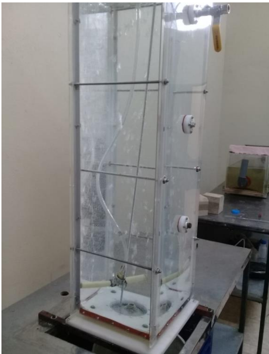
Anexo 1. Reactor secuencial tipo Batch (SBR), vacío y con carga de agua de la PTAR
