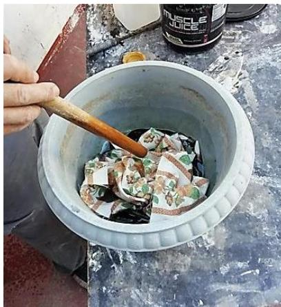
**Figura 64.** Colocación del textil en la resina.
