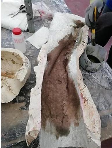
**Figura 50.** Aplicación de la resina sobre la fibra de vidrio.
