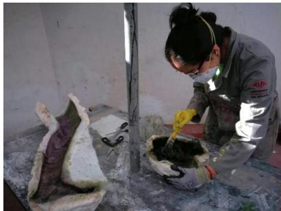
**Figura 51.** Aplicación de la resina sobre la fibra de vidrio.
