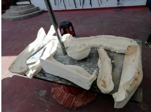
**Figura 47.** Moldes por partes.
