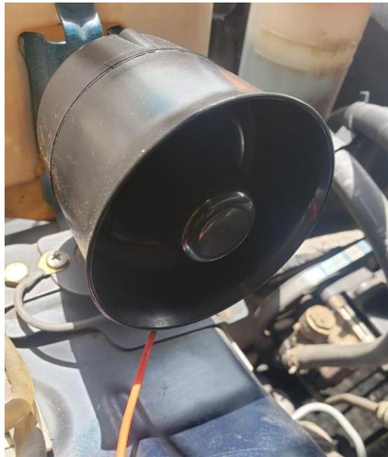
**Figura 3.48** Bocina del sistema de alarma
