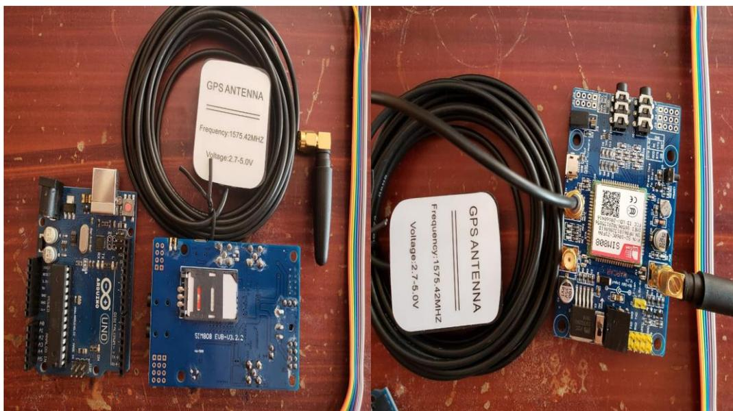
**Figura 2.25** Instalación tarjeta SIM y colocación de las antenas GPS y GPRS
