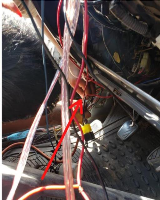
**Figura 3.43** Cable de alimentación de bomba de combustible
