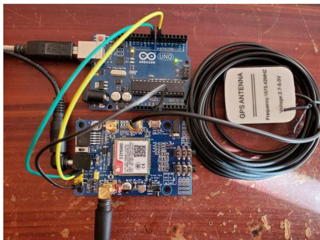
**EFigura 2.26** Instalación del módulo SIM808 con la tarjeta Arduino UNO
