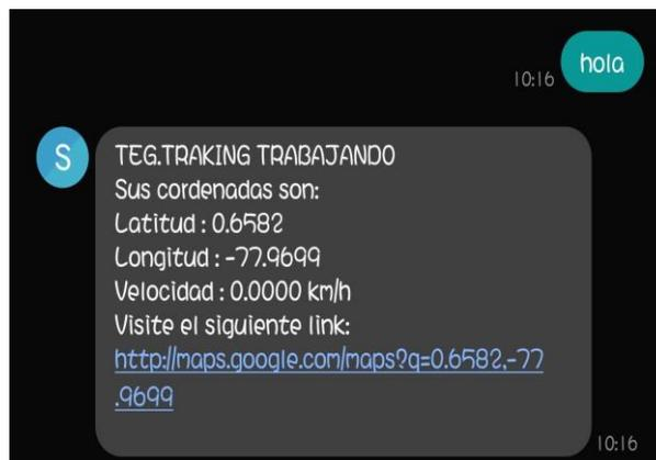
**Figura 3.58** Cuando llega el SMS de “hola” hacia el módulo SIM808
