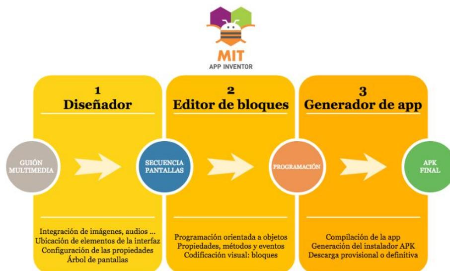
**Figura 1.6** Proceso de creación de una App con MIT App Inventor
