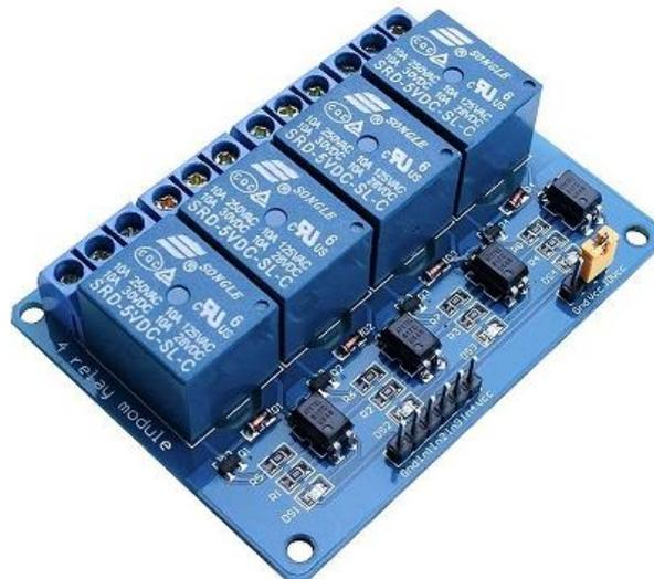
**Figura 2.18** Módulo relé de 4 canales
