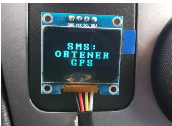
**Figura 3.57** Pantalla OLED, llegada del SMS de “hola” hacia módulo SIM808
