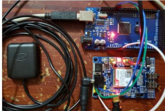
**Figura 3.17** Conexión SIM808 y Arduino
