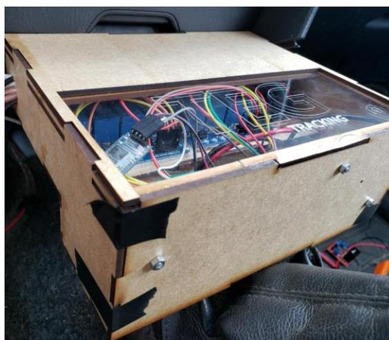
**Figura 3.41** Caja del prototipo montada en vehículo
