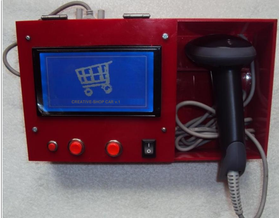
Fig. 29: Estructura montaje físico coche tarifador
