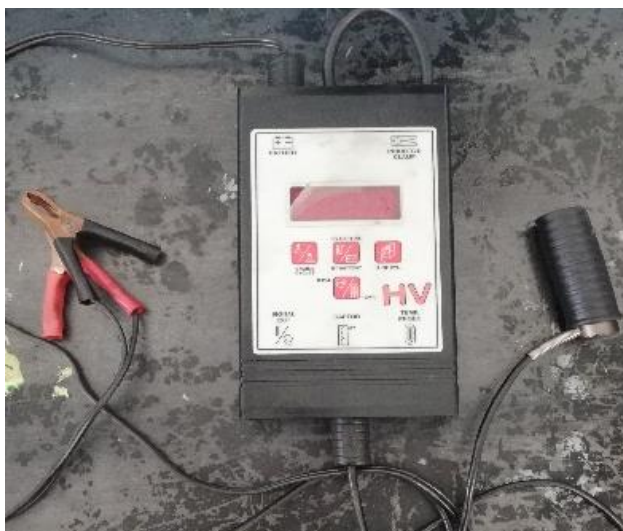
Figura 2.4 Tacómetro y medidor de temperatura MGT-300
