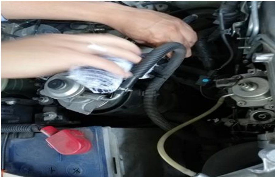
Figura II.1 Sustitución del filtro de combustible
