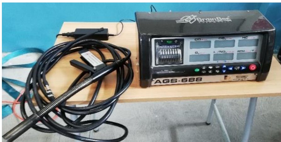
Figura 2.3 Analizador de gases Brain Bee AGS-688
