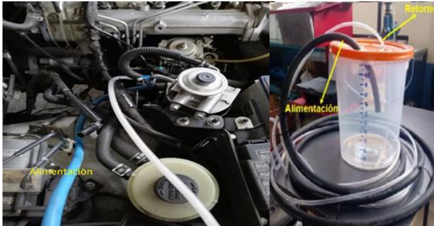
Figura 2.2 Adaptación de un tanque de suministro externo
