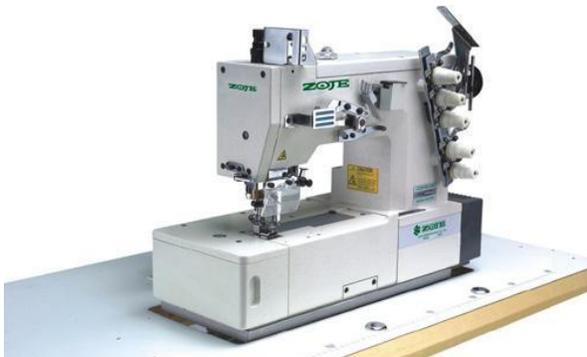
FIGURA # 3. MÁQUINA RECUBRIDORA
