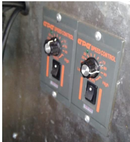
Figura 20: Potenciómetros que controlan la velocidad de los motores
