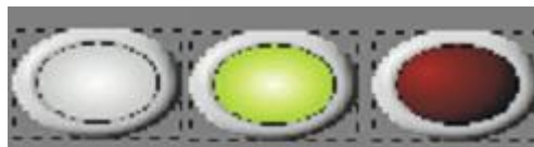
Figura 63: Led indicador de estado de secuencia, apagado, en marcha y fallo.
