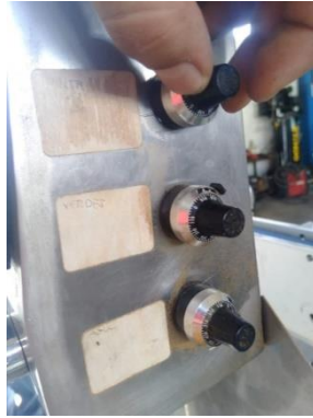
Figura 19: Potenciómetros que controlan la velocidad de los motores
