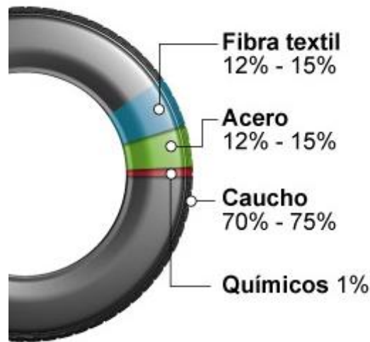
Figura 1. Composición de un neumático [4].
