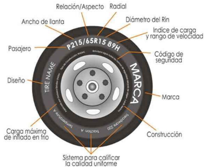
Figura 5. Nomenclatura de un neumático [17].
