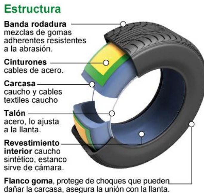
Figura 2. Estructura de un neumático [4].
