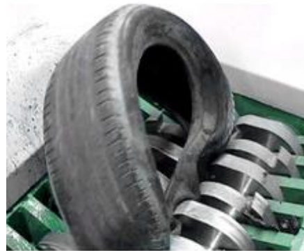
Figura 7. Trituración primaria de un neumático [13].
