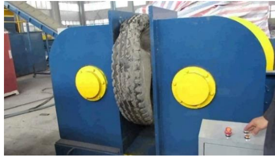
Figura 6. Extracción del aro de talón del neumático [15].
