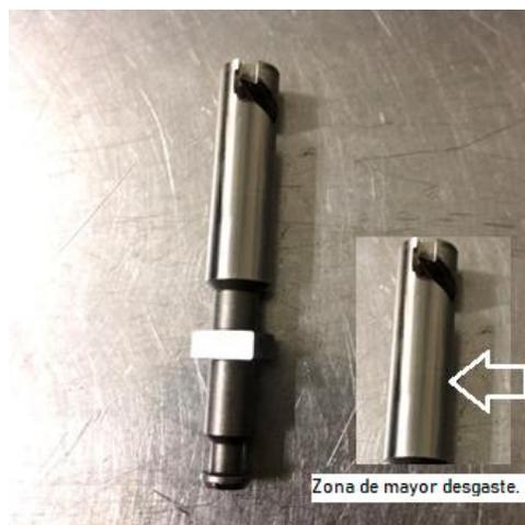
**Figura 3.4** Émbolo desgastado de bomba de inyección en línea
