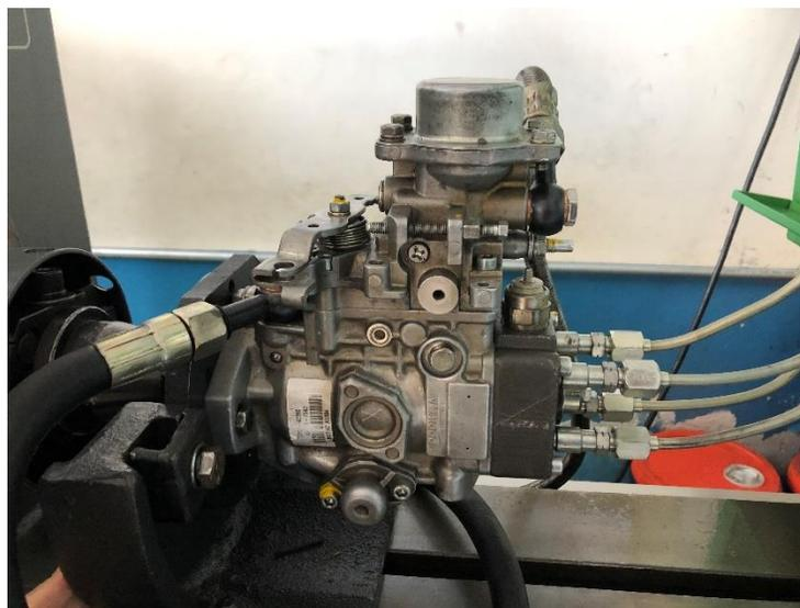
Figura A.III. 1 Montaje y calibración de una bomba de inyección rotativa
