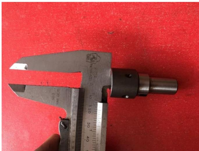
**Figura 2.3** Medición del cilindro de una bomba de inyección en línea
