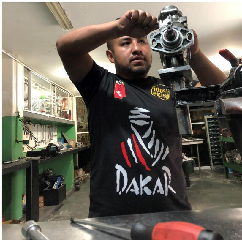
**Figura A.II. 4** Ajuste de la bomba de inyección rotativa
