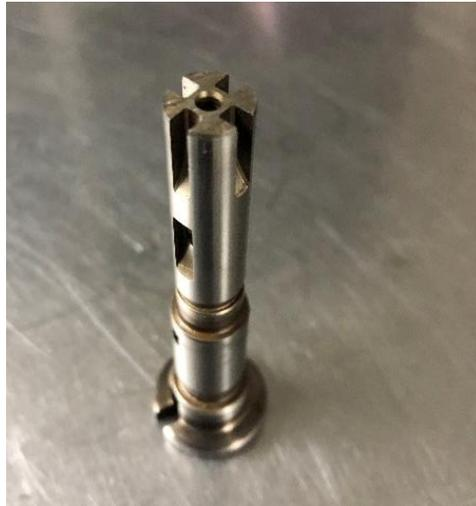
**Figura 2.8** Émbolo de bombeo de una bomba de inyección rotativa
