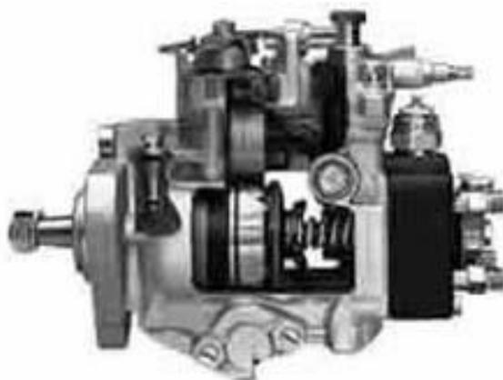
**Figura 1.7** Bomba rotativa de cuatro salidas
