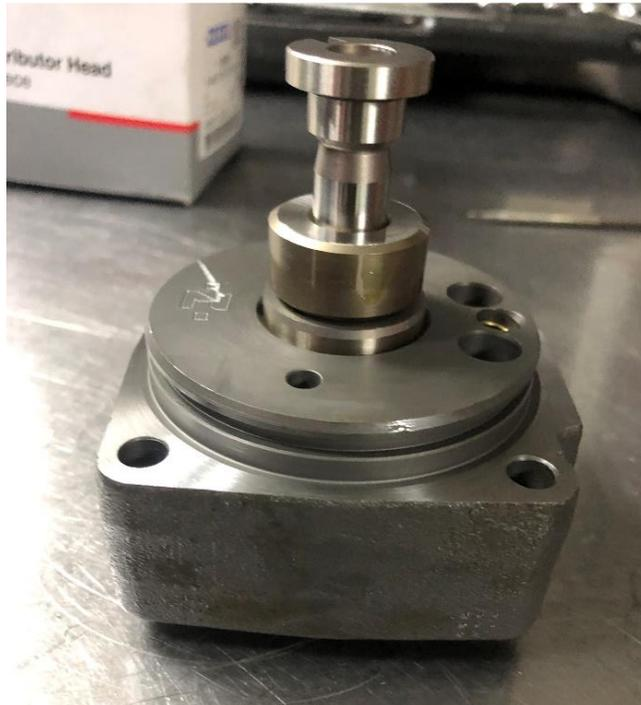
**Figura 2.6** Cilindro o cabezal hidráulico con su respectivo émbolo
