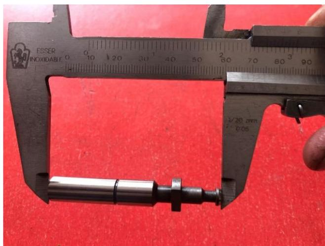
**Figura 2.5** Medición de un émbolo de bombeo
