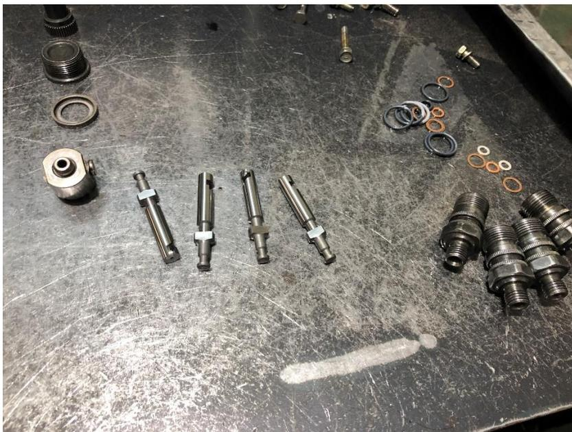
**Figura A.II. 2** Elementos internos de una bomba de inyección lineal
