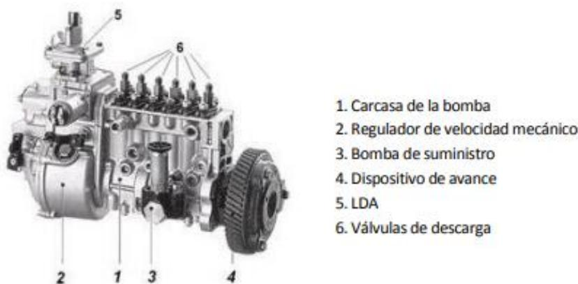
**Figura 1.2** Bomba de inyección de elementos en línea Bosch
