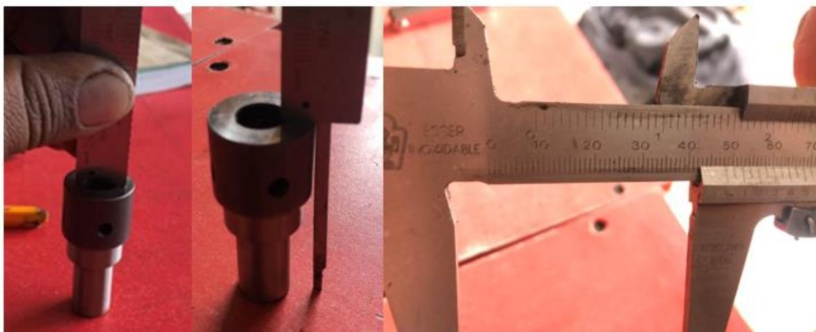
**Figura 3.2** Obtención de las dimensiones de un cilindro de bomba
