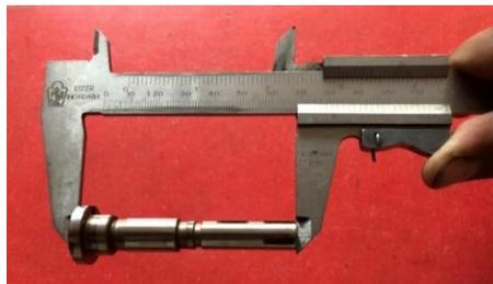
**Figura 2.9** Obtención de medidas de un émbolo de bomba rotativa
