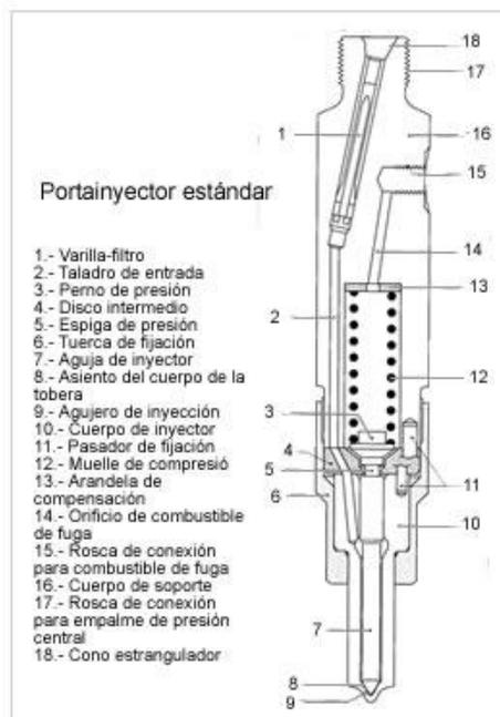
**Figura 1.9** Elementos de un inyector de inyección directa
