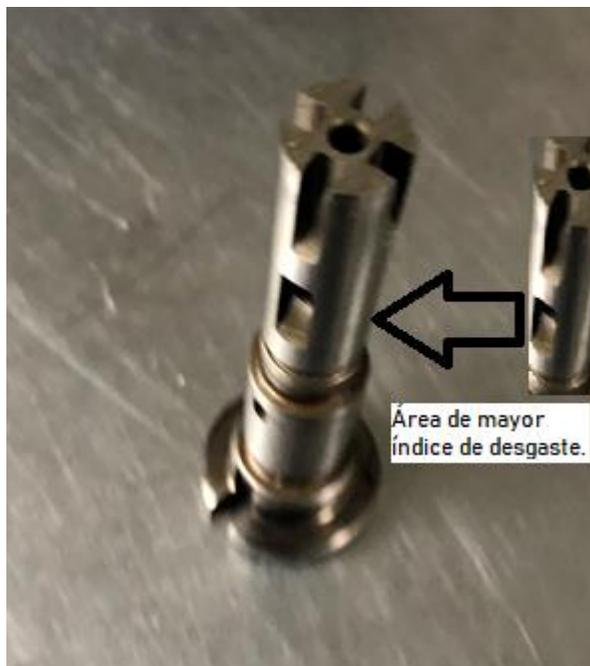
**Figura 3.9** Émbolo desgastado de una bomba de inyección rotativa
