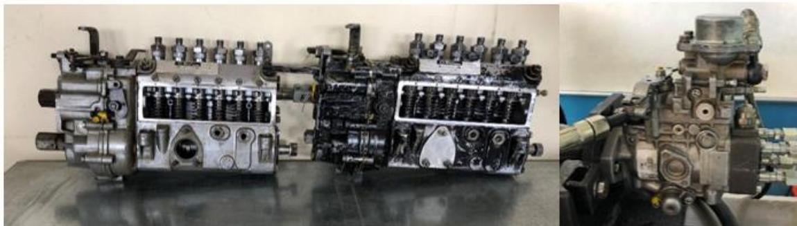
**Figura 2.1** Bombas de inyección mecánicas lineales y rotativa
