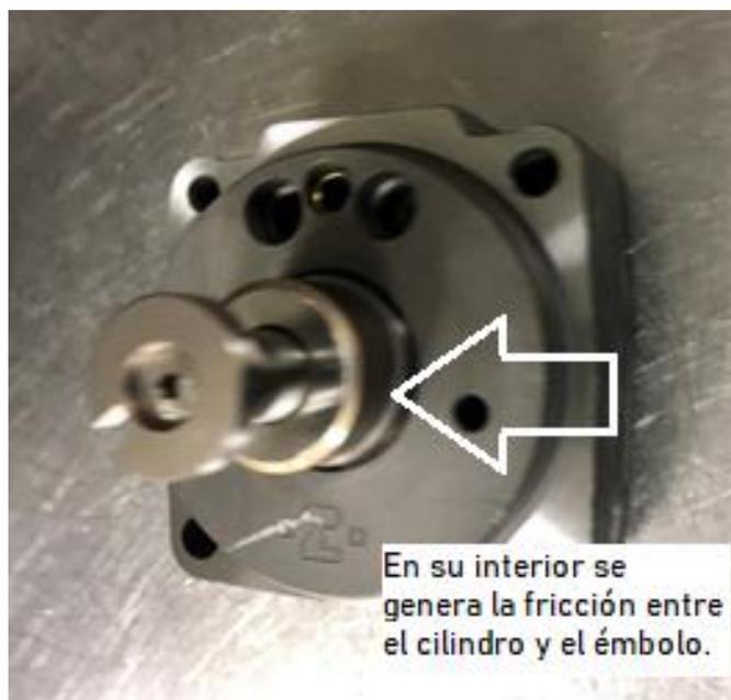
**Figura 3.7** Cabezal hidráulico de una bomba de inyección rotativa
