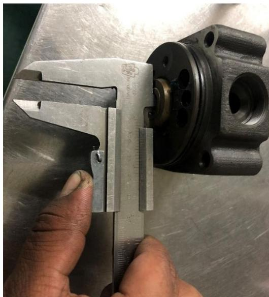
**Figura 2.7** Medición del cilindro o cabezal hidráulico de una bomba rotativa
