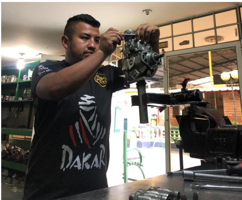
**Figura A.II. 3** Montaje de una bomba de inyección rotativa
