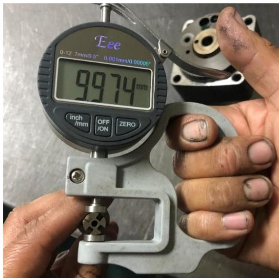
**Figura 3.10** Dimensiones de un émbolo completamente usado
