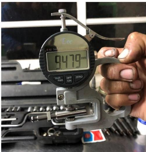
**Figura 3.5** Medición del émbolo desgastado de una bomba de inyección en línea
