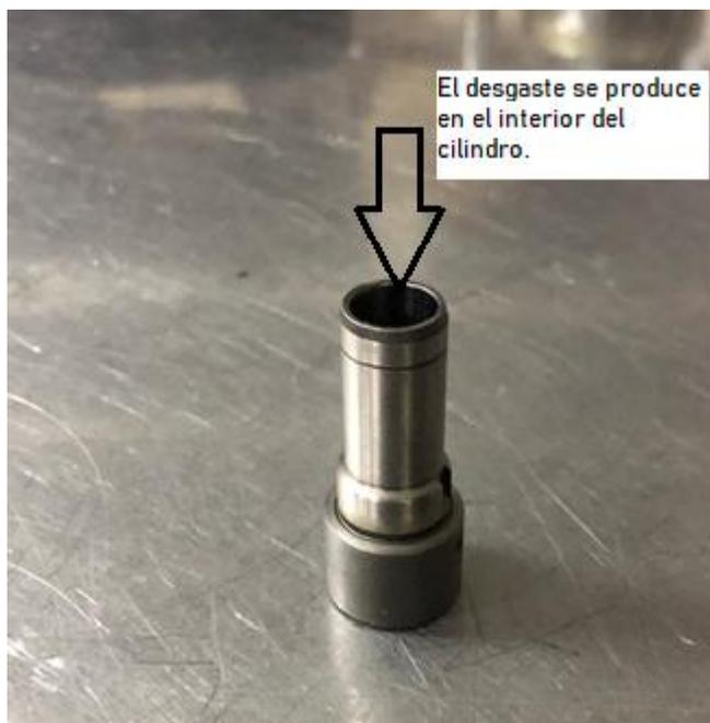
**Figura 3.1** Cilindro desgastado de bomba de inyección en línea
