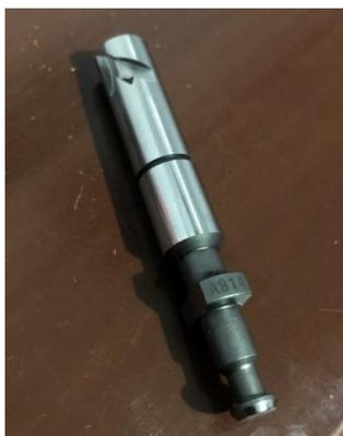
**Figura 2.4** Émbolo de inyección de una bomba de elementos en línea
