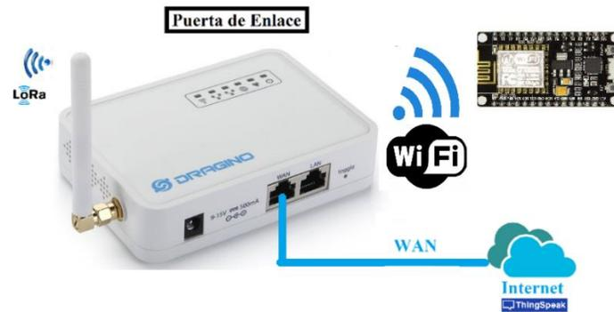
Figura 67. Comunicación entre Dragino y módulo MCU ESP-8266.
