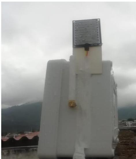
*Figura 81.* Prueba de nodo recolector ante presencia de lluvia.
