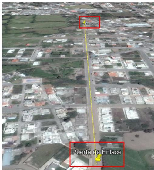
Figura 94. Línea de vista del nodo 1-1-4 y la puerta de enlace.
