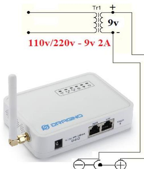
Figura 50. Fuente de energía de la puerta de enlace Dragino.
