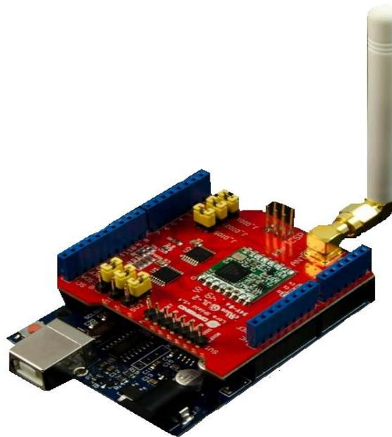
*Figura 33.* Módulo LoRa, montado en placa Arduino.
