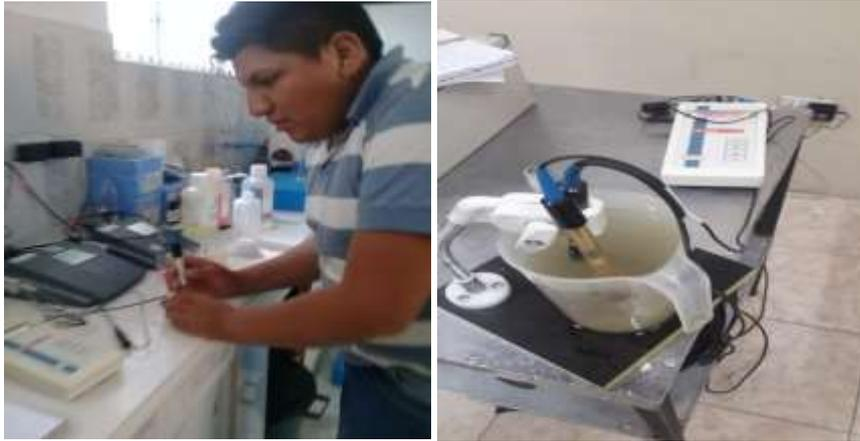
*Anexo 2.6. Calibración y toma de datos con el multiparámetro contsor*
