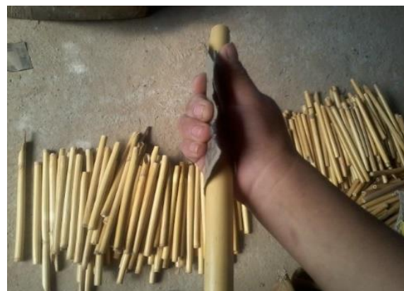
Ilustración 49. Lijado Externo de la Pared de la Sección Cortada del Bambú
