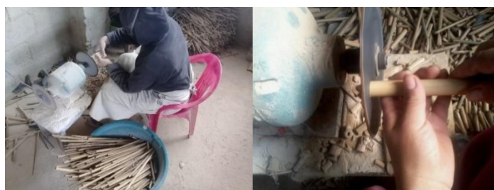
Ilustración 52. Lijado de los extremos de los tubos
