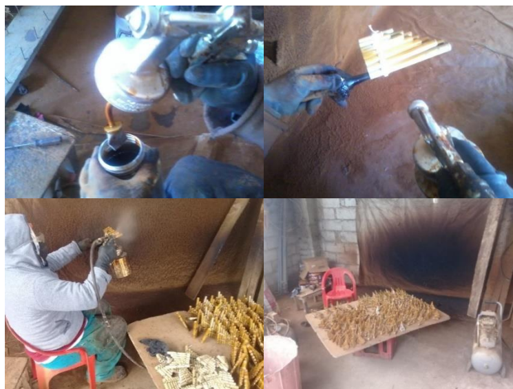
Ilustración 56. Proceso de barnizado
