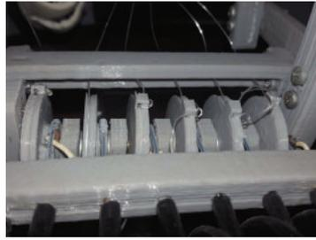
*Figura 54. Multiplicador de desplazamiento del SMA y del tendón*
