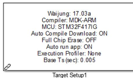
**Figura 45.** Bloque de configuración de la tarjeta STM
