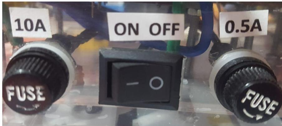
*Ilustración 4. Interruptor y portafusibles de 10 y 0,5 Amperios respectivamente*
