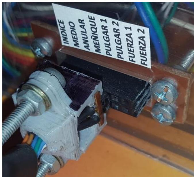
*Ilustración 2. Conexión del socket de sensores de flexión*
