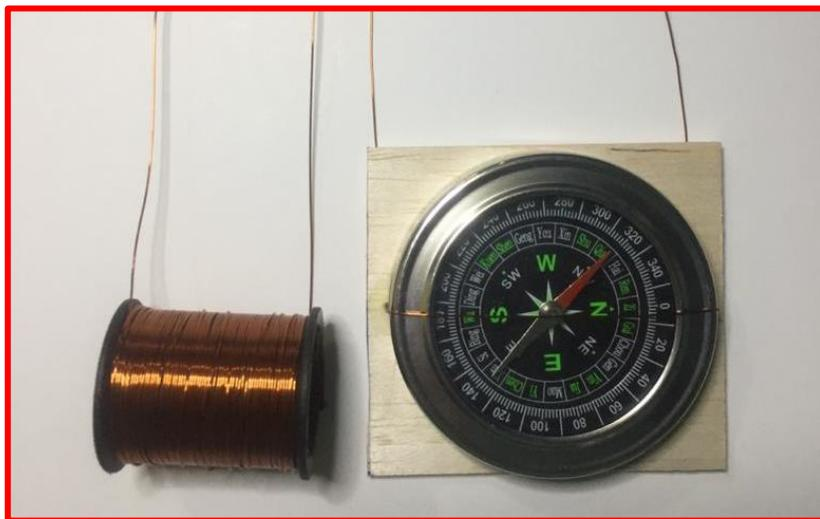
*Figura 2 Prototipo sobre el principio de Faraday*
