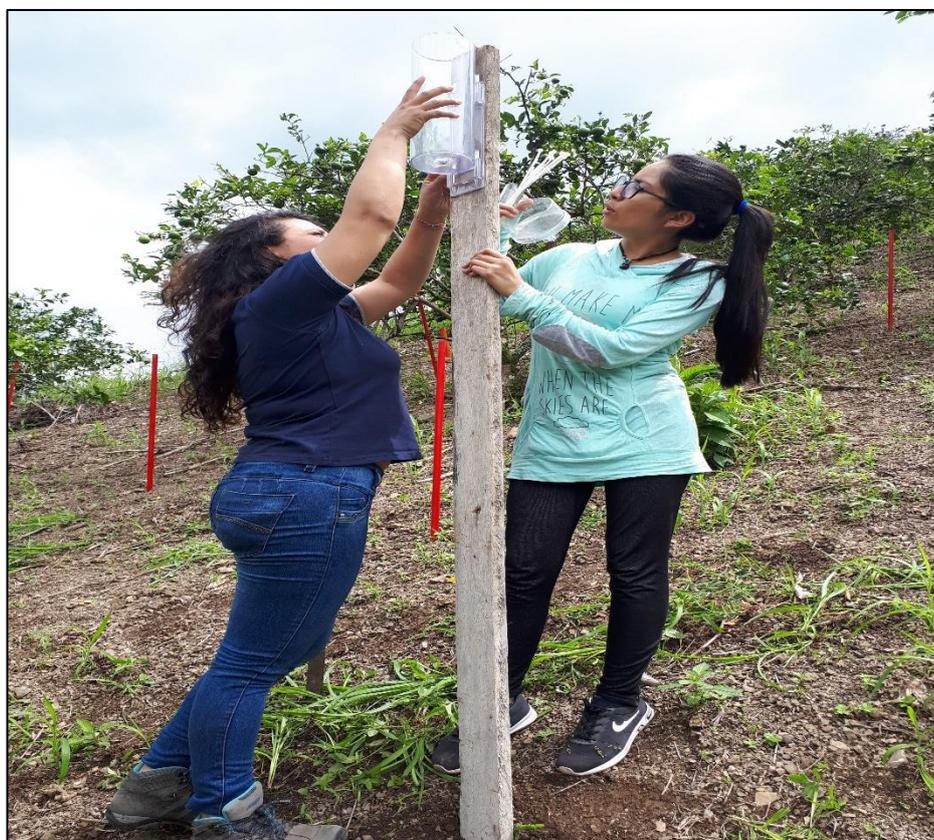
**Fotografía 8.** Instalación de pluviómetros cada ensayo
