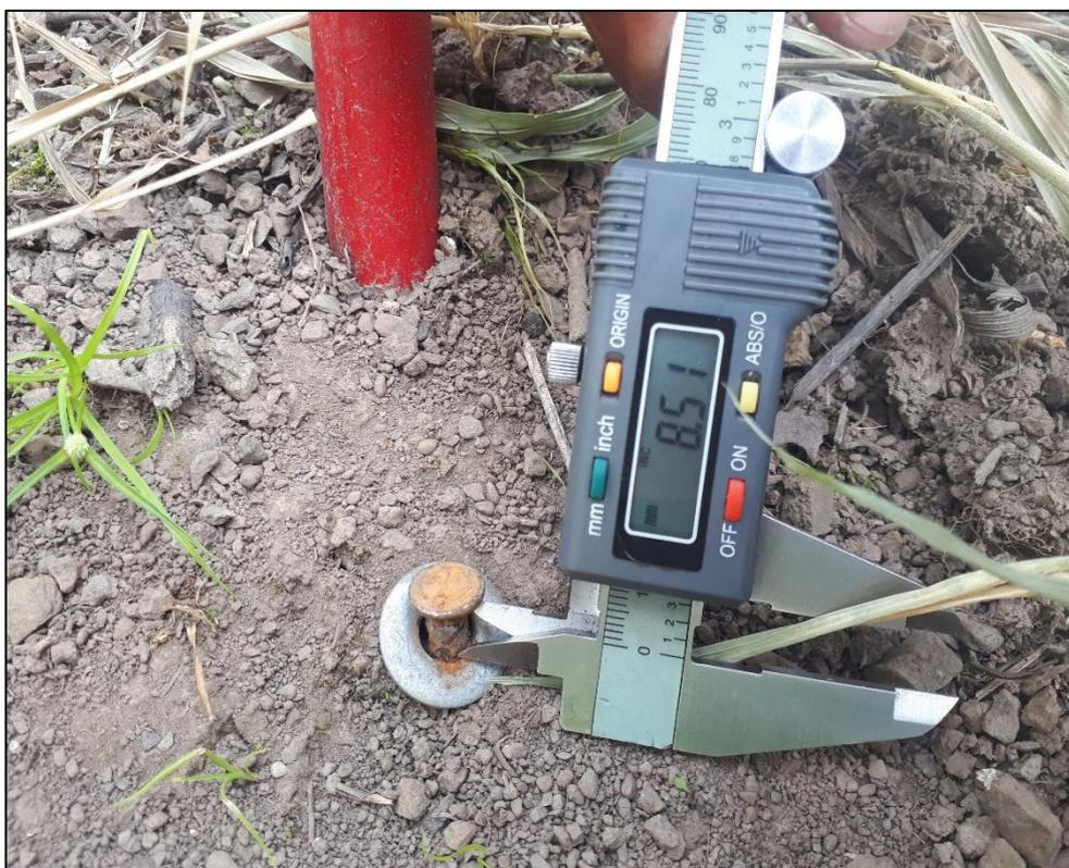
**Fotografía 6.** Medición mensual de clavos de erosión con calibrador electrónico
