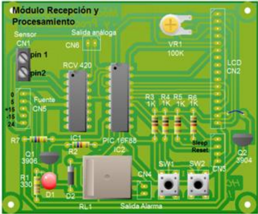
Fig 9 Diseño en PCV Wizard de placa del dispositivo detector de fugas
