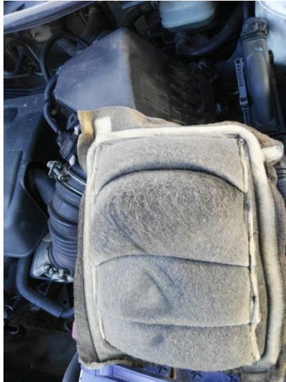
Anexo 10: Parte interna del filtro de aire de lana.
