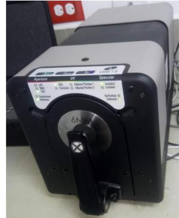
**Figura 33** *Espectrofotómetro*
