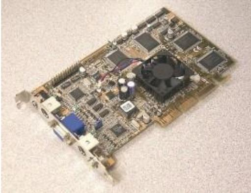
Una tarjeta ASUS basada en el GeForce 256, primer en incorporar Transform & Lighting por hardware
