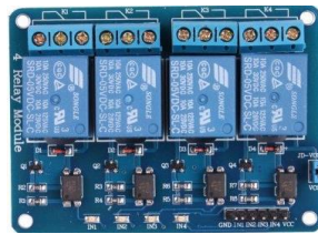
Figura 9. Módulo relé electromecánico de 4 canales [31].
