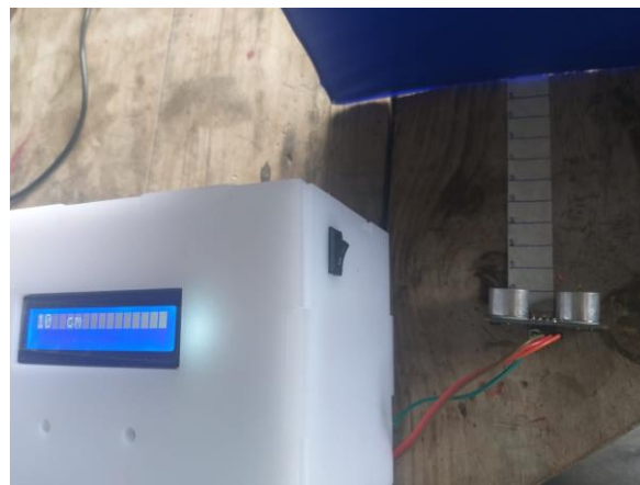
Figura 21. Calibración y pruebas del sensor ultrasónico 10cm.
