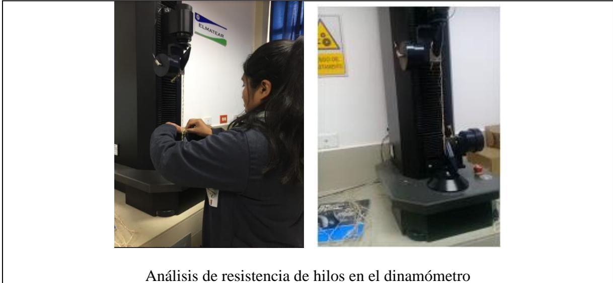
Análisis de resistencia de hilos en el dinamómetro
