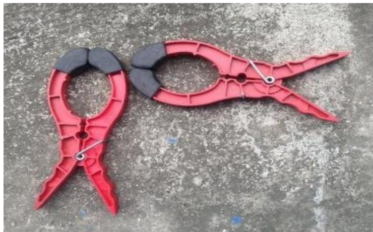
Gráfica 27. Pinzas Plásticas para Sujetar Mantas Aislantes
