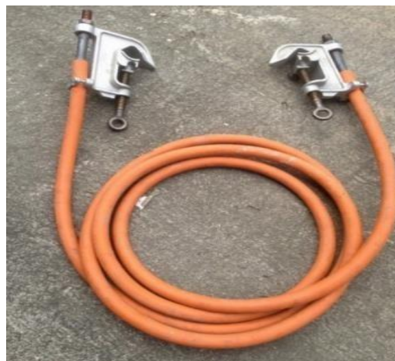
Gráfica 29. Cable de puente Aislado de 15 kV
