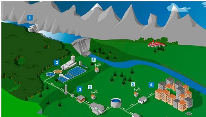
Figura 2.1 Sistema de abastecimiento de agua
