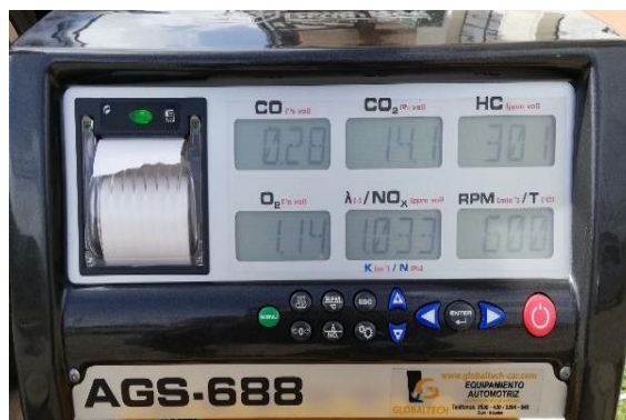
Figura 2.3 Analizador de gases de escape Brain Bee.
