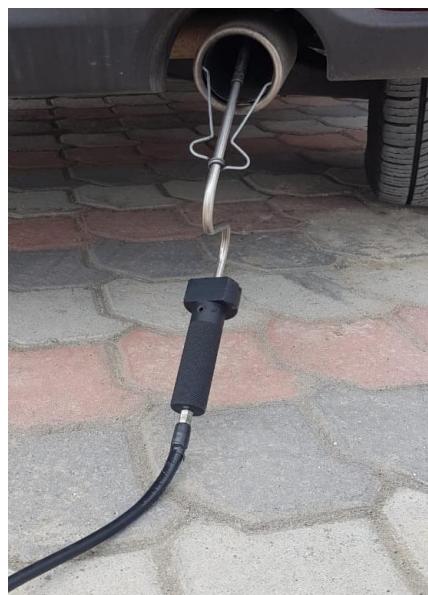
Figura 2.12 Instalación de la sonda del analizador de gases de escape
