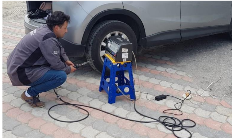
Figura 2.9 Instalación del analizador de gases
