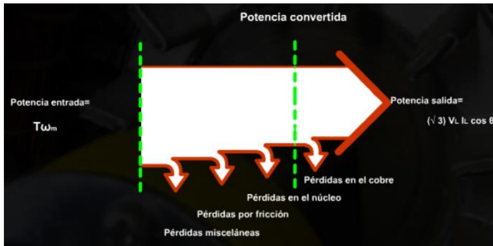
Fig. 17 Diagrama de pérdidas de potencia Fuente:(León & Alexander, 2008)
