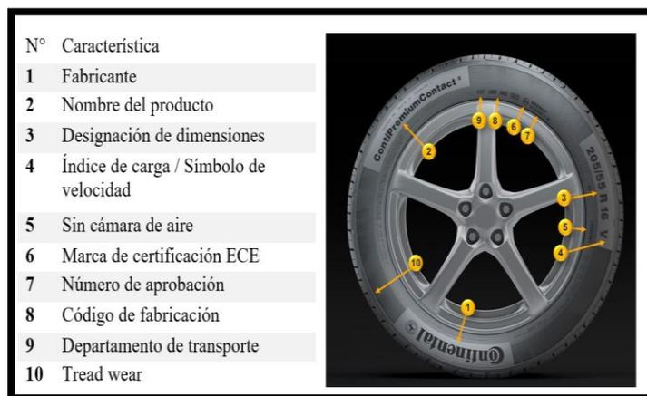
Figura 3. Identificación del neumático [20].
