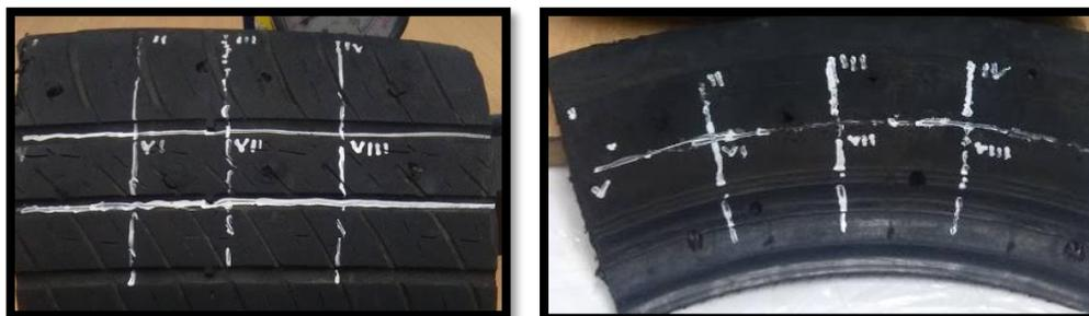
Figura 7.- Izquierda; Perforaciones Banda de Rodadura. Derecha; Perforaciones Cara Lateral.
