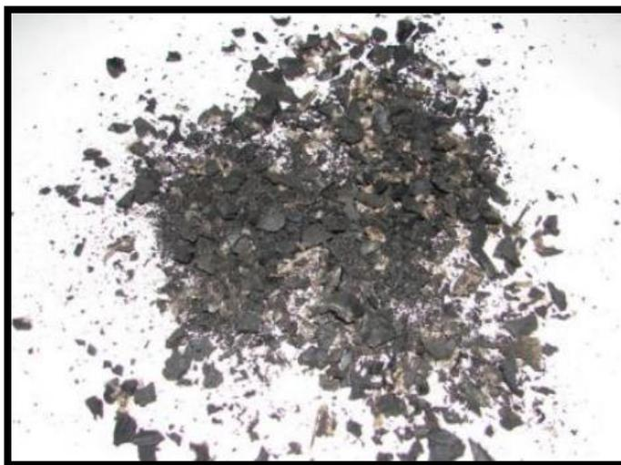
Figura 12. Caucho granulado [22].
