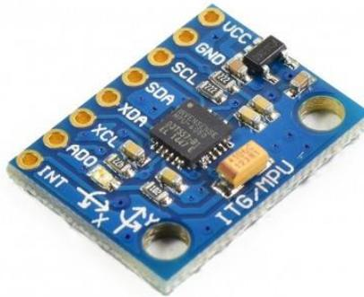
Figura 21 Sensor MPU 6050
