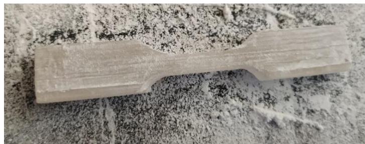
Fig. 2-14 Lijado de Probetas
