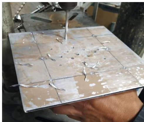
Fig. 2-8 Perforación de agujeros en la plataforma
