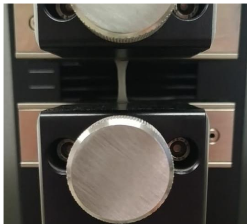
Fig. 3-3 Sujeción de mordazas y alineamiento de probeta
