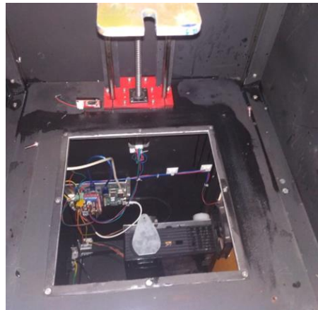
Fig. 2-7 Fugas de la cuba
