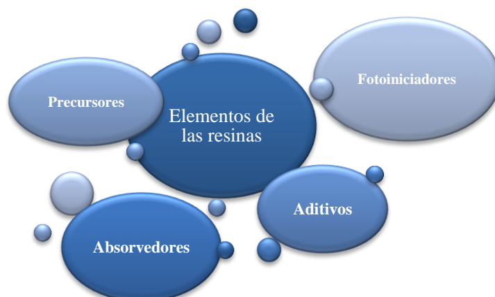
Fig. 1-4 Componentes de la resina [10]
