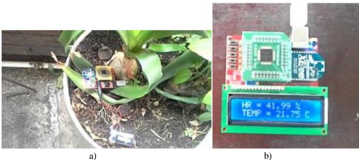
Figura 1.8: Pruebas de implementación, a) nodo coordinador y b) nodo sensor
