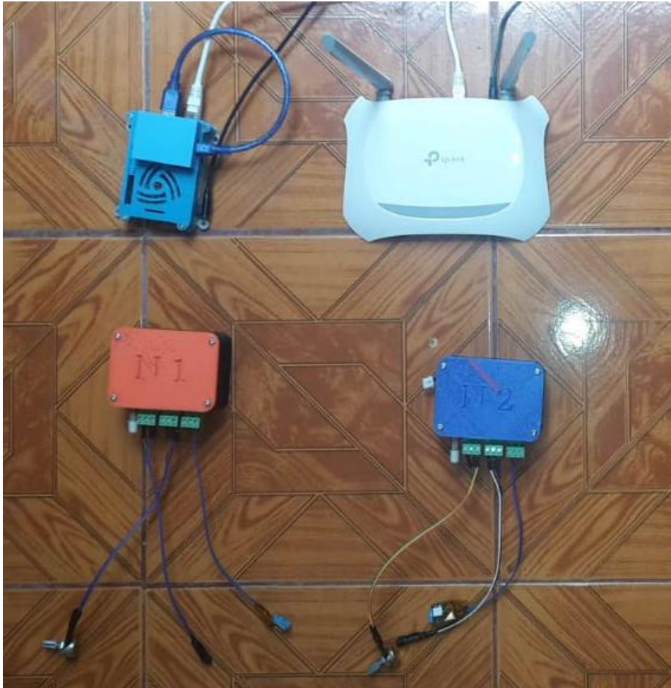
Figura 35: Sistema de red WSN conectado a la red local
