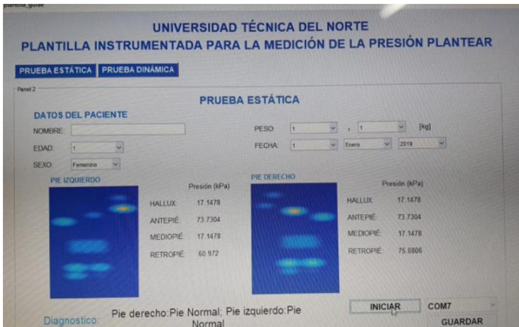
Figura 39. Presiones obtenidas en prueba estática
