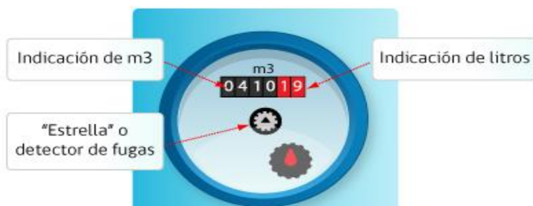
Figura 5. Indicador numérico de un medidor convencional
