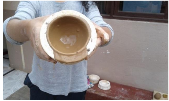
Figura 72. Compactación de la arcilla en el molde. Fuente: Fanny Flores (2019).
