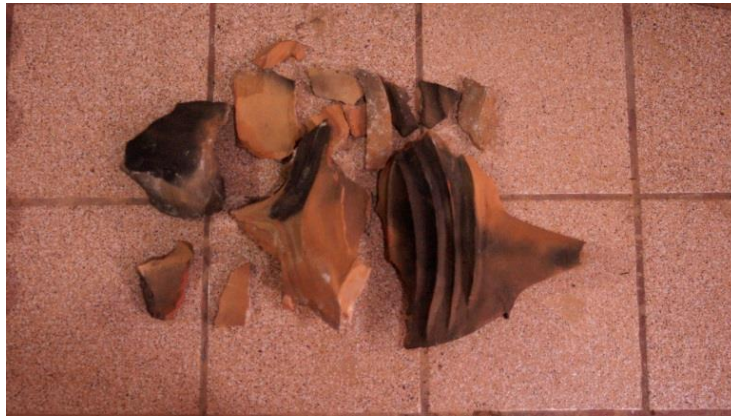
Figura 79. Partes de la pieza fragmentada en la quema.
