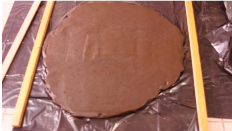
Figura 42. Arcilla extendida. Fuente: Autoría propia
