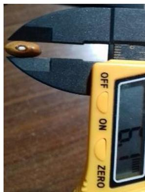
*Figura 8.* Medición del grosor de la semilla de fréjol
