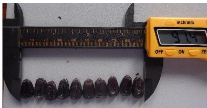
*Figura 15.* Medición del ancho del grano de maíz
