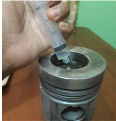
**Figura 2.12** Toma del volumen de la cámara del pistón
