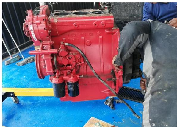
**Figura 2.2** Extracción del motor
