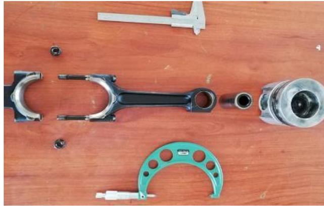
Figura 1. Herramientas utilizadas para toma de medidas
