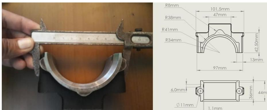
**Figura 2.11** Medidas de la bancada del cigüeñal y biela
