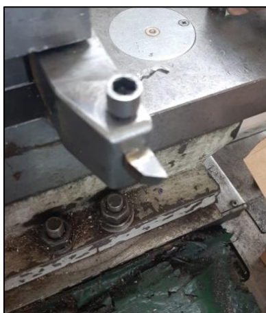
Figura 2.2 Cuchilla de widia para exteriores y corte.
