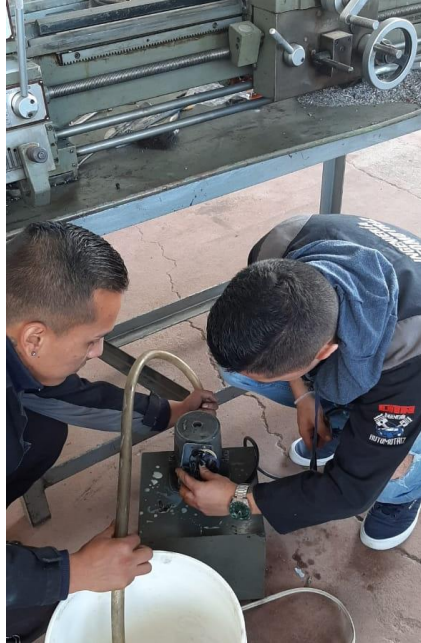
Figura A.I.1 Comprobación funcionamiento bomba
