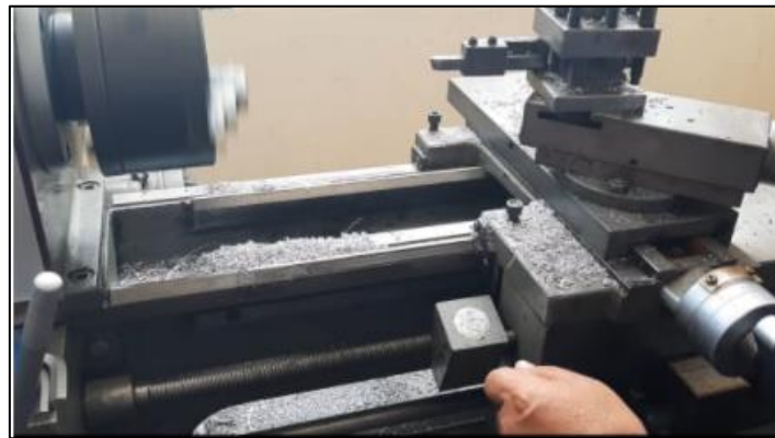
Figura 3.13 Fabricación de probetas en el torno.
