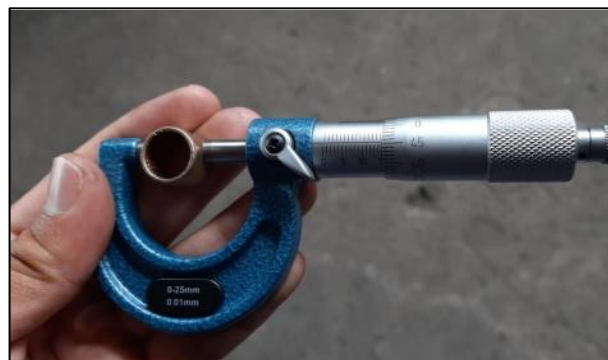
Figura 2.5 Medición diámetro exterior.
