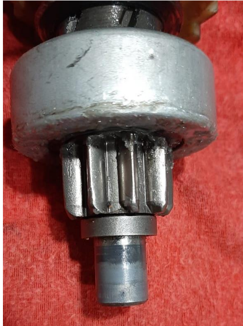
Figura A.IV.1 Reemplazo del bocín original en el eje del motor de arranque.
