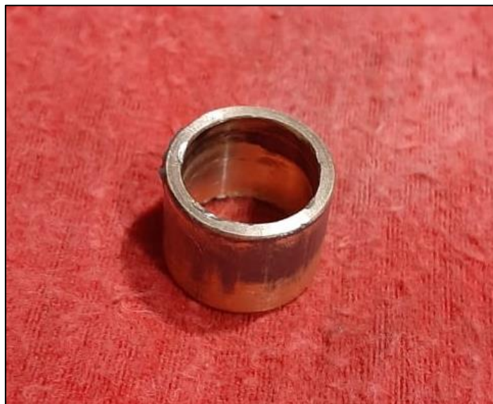
Figura A.V.2 Desgaste – Bronce Fosfórico SAE 640
