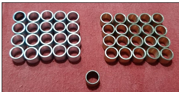
Figura 3.14 Probetas de aluminio y bronce elaboradas.
