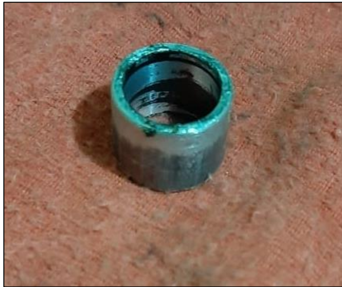
Figura A.V.1 Desgaste – Aluminio al silicio 3xx.x
